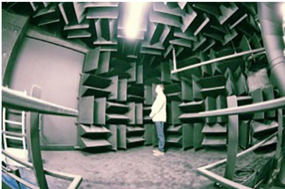
Figura 2. Acondicionamiento acústico detrás de la esfera que da al espacio características anecoicas.
