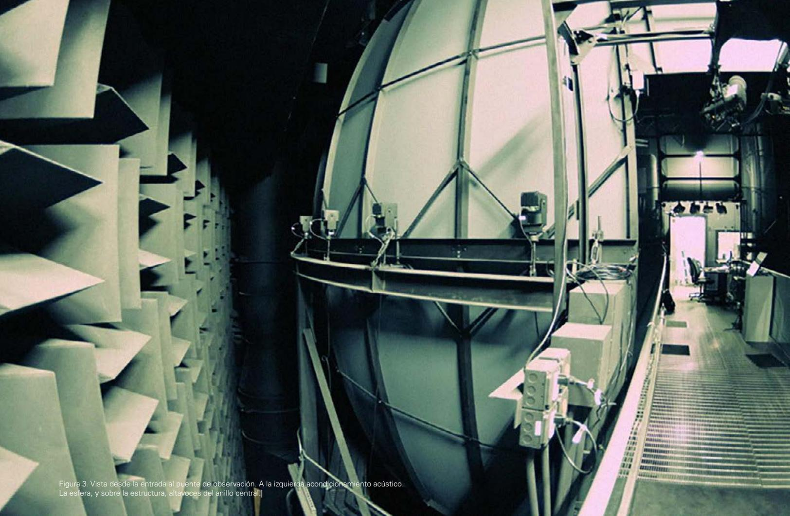
Figura 3. Vista desde la entrada al puente de observación. A la izquierda acondicionamiento acústico. La esfera, y sobre la estructura, altavoces del anillo central.
