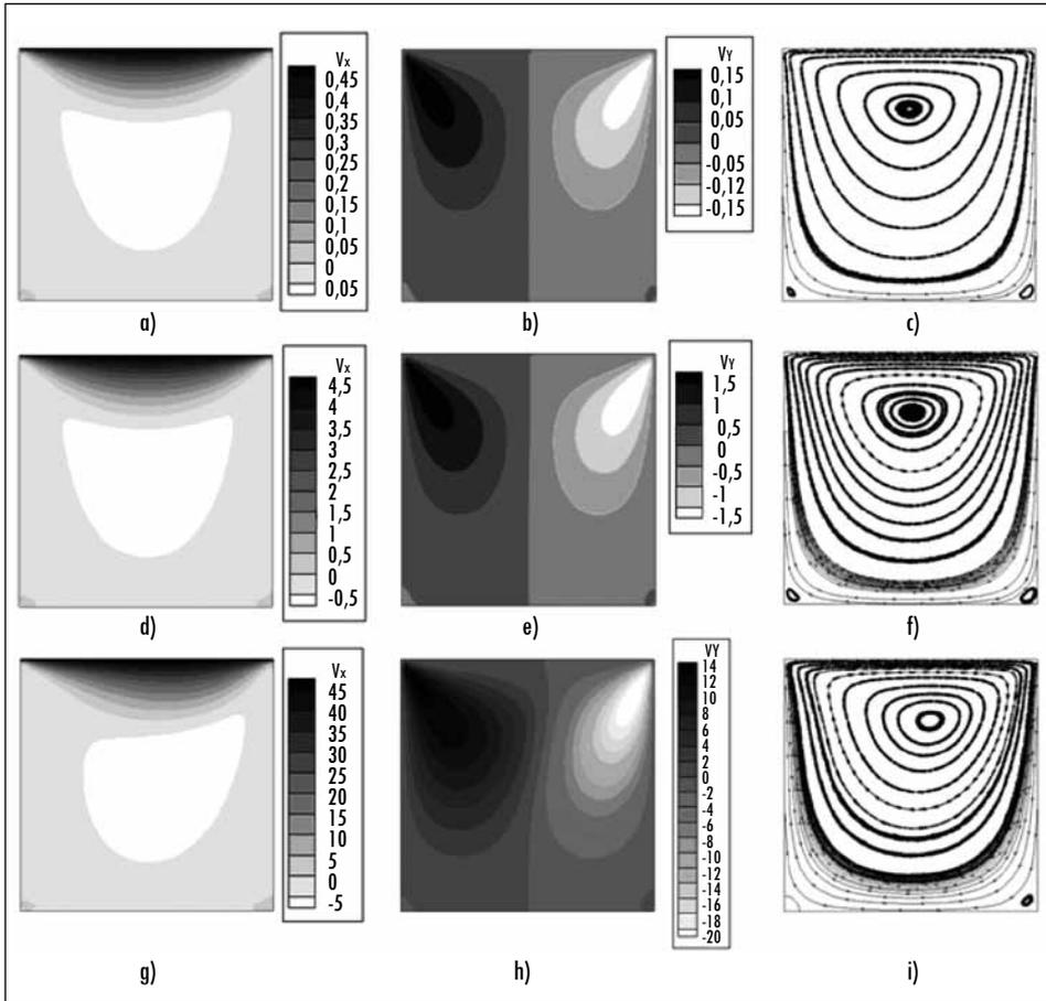
a), d) y g) muestran los resultados para la velocidad en x con números de Reynolds de 0,5, 5 y 50, respectivamente. b), e) y h) muestran los resultados para la velocidad en y, y c), f) e i) muestran los resultados para las líneas de corriente.
