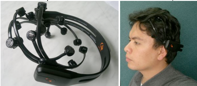
Figura 3. Interfaz de Captura de Neuroseñales de Alta Resolución (Emotiv Headset)
