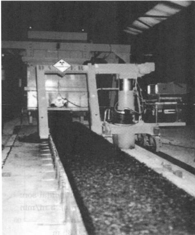
Por razones de un comando único del convertidor de frecuencias, la frecuencia de vibración de la placa es idéntica a aquella del carrito vibrante.
