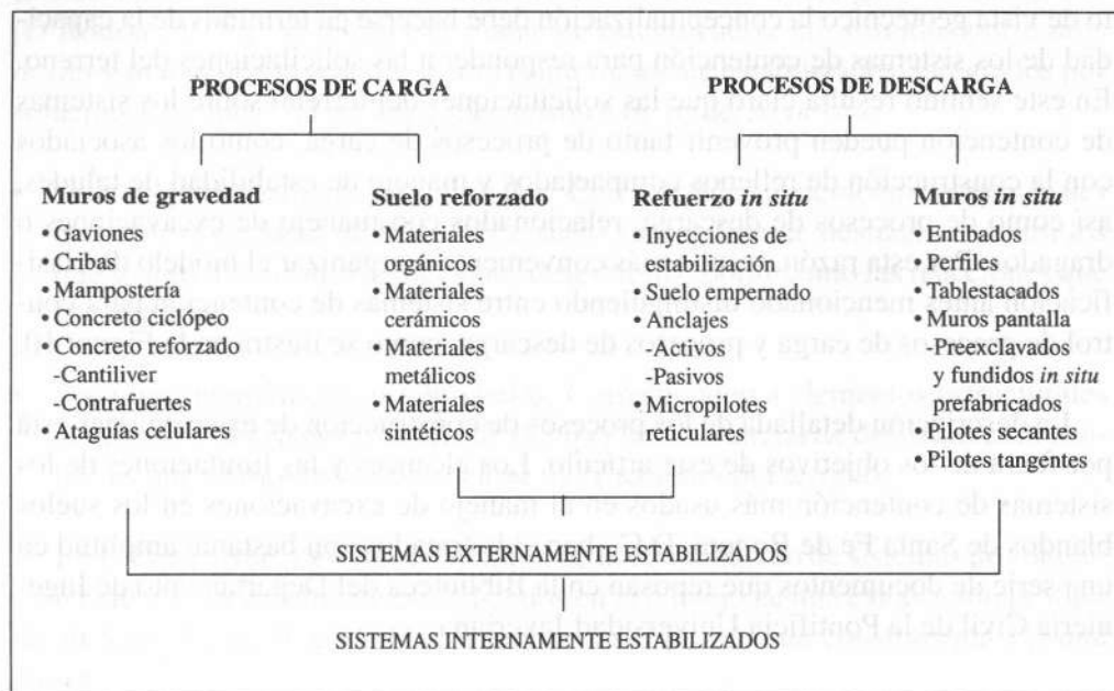
Figura 10. Clasificación de sistemas de contención Enfoque geotécnico - Aplicabilidad de acuerdo con el tipo de sollicitación del terreno
