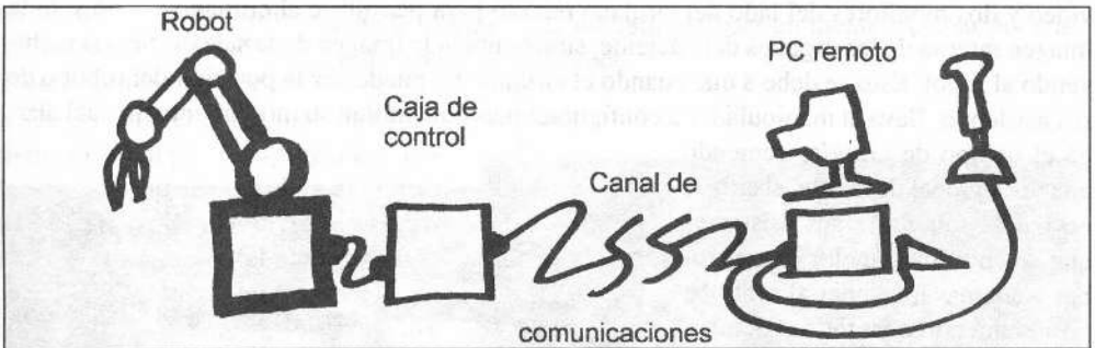
Figura 1. Esquema de manipulación del robot accionado por telemando.
