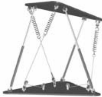
Figura 8. Plataforma paralela basada en sistemas tenségricos.
