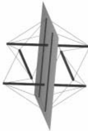
Figura 4. Estructura tenségrica geodésica de seis barras
