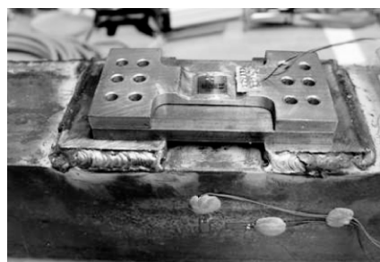
Figura 3. Modelo a escala 1:25 del puente Salgar. Figura 4. Galgas extensiométricas sobre platinas
