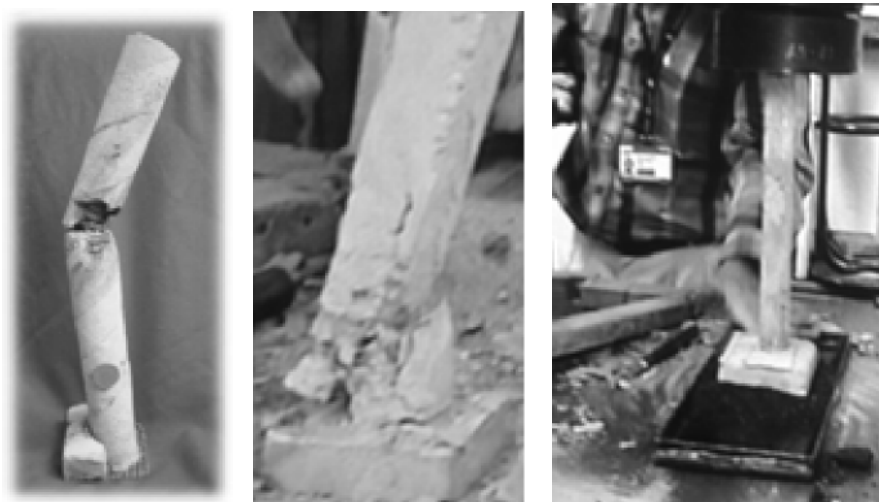
Figura 9. a) y b) Esquema de falla de columnas de mortero armado; c) Montaje de un sistema zapata-columna
