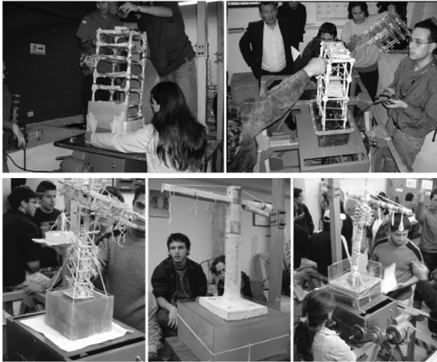
Figura 6. Edificios y grúas sometidas a movimientos en la base mediante una mesa vibratoria
