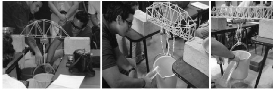
Figura 4. Esquema de aplicación de carga mediante agua y mediante pesas de acero
