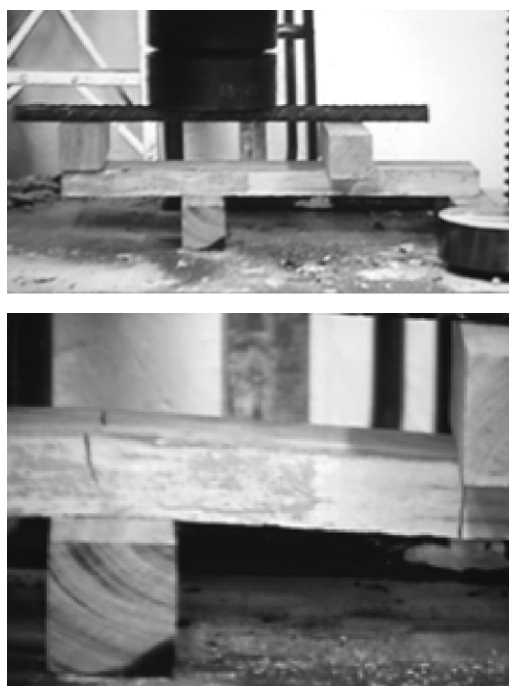
Figura 8. Montaje y ensayos de pequeñas vigas de mortero reforzado
