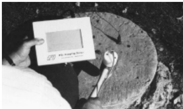
Figura 2. Prueba de Integridad del Pilote (PIT)
