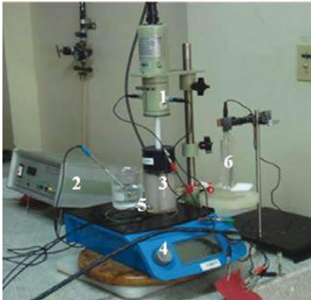
Figura 2. Montaje experimental para el desarrollo de las pruebas electroquímicas de corrosión, corrosión asistida por erosión y erosión-corrosión
