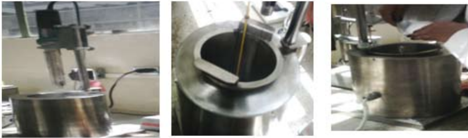
Figura 2. Proceso de modificación de asfaltos con el dispersor
