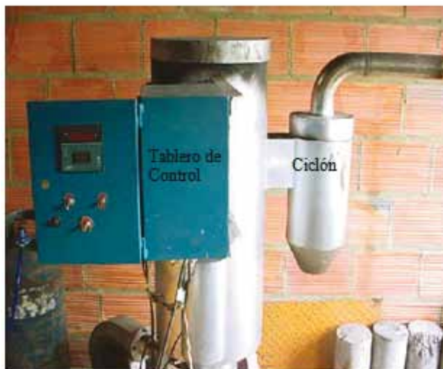
Figura 2. Reactor de lecho fluidizado burbujeante
