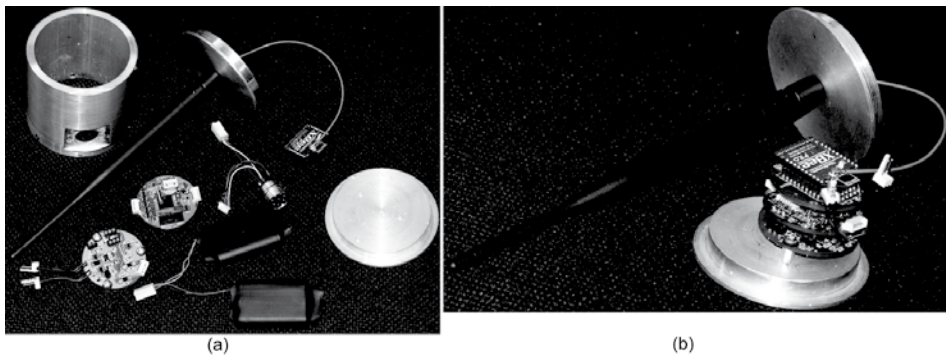
Figura 3. Nodo sensor desarrollado. (a) Partes constitutivas del nodo. (b) Nodo totalmente ensamblado
