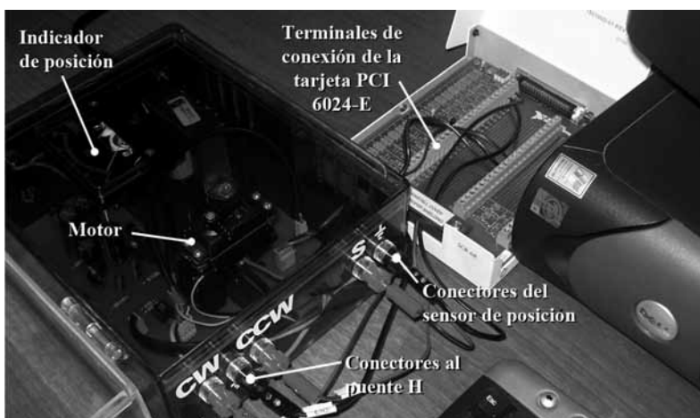
Figura 1b. Montaje real en el laboratorio de la configuración en lazo cerrado para controlar la posición del motor y el montaje mecánico
