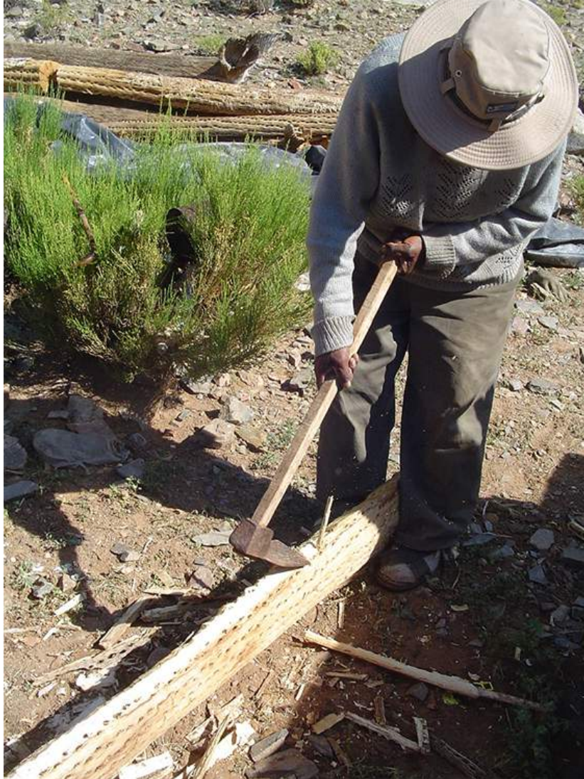
FIGURA 6. Proceso de azuelado para la conformación de las tablas de madera de cardón Fuente: elaboración propia
