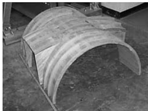
Figura 10: Modelo a escala de secciones de la bóveda de San Ignacio.
