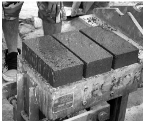
Figuras 10 y 11: Máquina de BTC, modelo adaptado de la CINVA RAM. Autor: Célia Neves.
