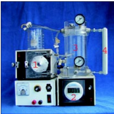
Figura 2. Estación de ultrafiltración para separación de proteínas que consta de: bomba peristáltica (1), agitador magnético (2) y reservorio (3), que incluye los controles de presión y los conectores para el cartucho de filtración (4).
