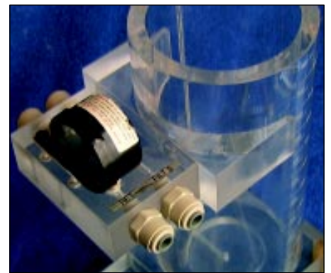
Figura 7. A una distancia de 14 cm por encima del bloque inferior, se fijó una base con su cara posterior cóncava y su cara anterior plana (figura 18). La concavidad correspondía a la superficie externa del reservorio y permitió adosar la base a la superficie externa del mismo. El manómetro permite medir la presión de retenidos.
