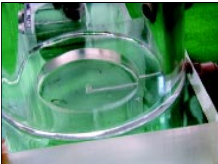
Figura 5. En el centro de la base se fresó una depresión circular de 0.8 cm de profundidad y 5 cm de diámetro para alojar el magneto de agitación.
