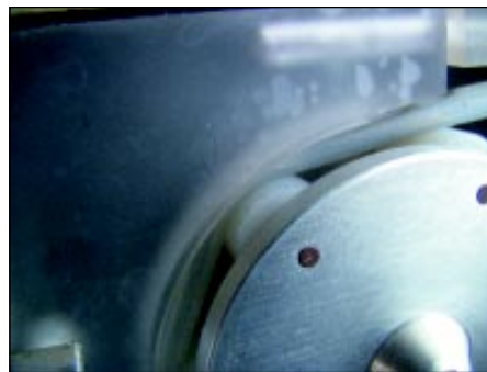
Figura 3. La bomba peristáltica emplea rodillos que presionan la manguera elástica sobre una superficie dura.
