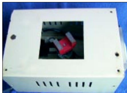
Figura 4. A la superficie superior de la caja se le hizo un orificio cuadrado de 9 x 9 cm que luego se cubriría con lámina de acrílico de 1.5 mm.
