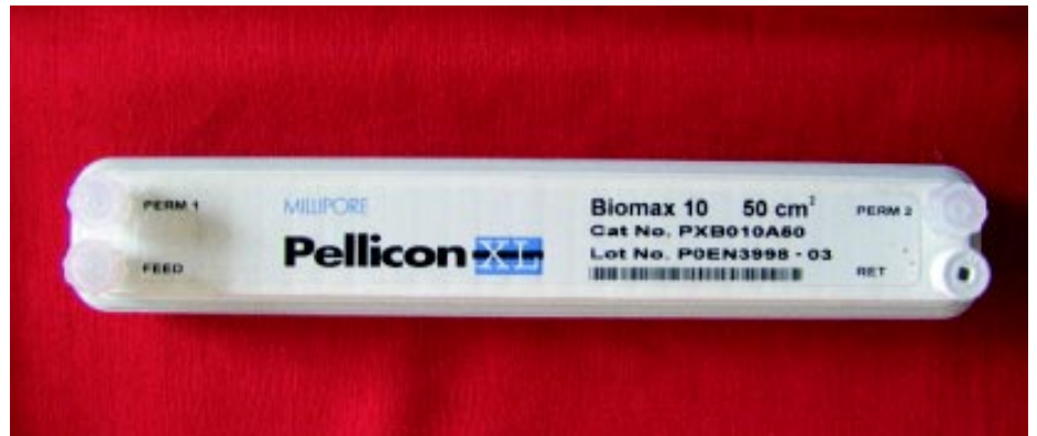
Figura 10. El cartucho de filtración utilizado en la investigación es el Pellicon® XL Biomax 10. La membrana de polietersulfona tiene un tamaño de poro de 1000 Da, con un área de filtración de 50 cm 2 y una capacidad de 3.2 ml. El volumen óptimo de flujo tangencial es de 30 - 50 ml /min y la compatibilidad de pH es de 1 -14.
