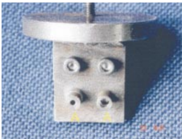
Figura 1a. Segmento superior del aparato para realizar prueba de flexión y tensión, (A)=vigas.
