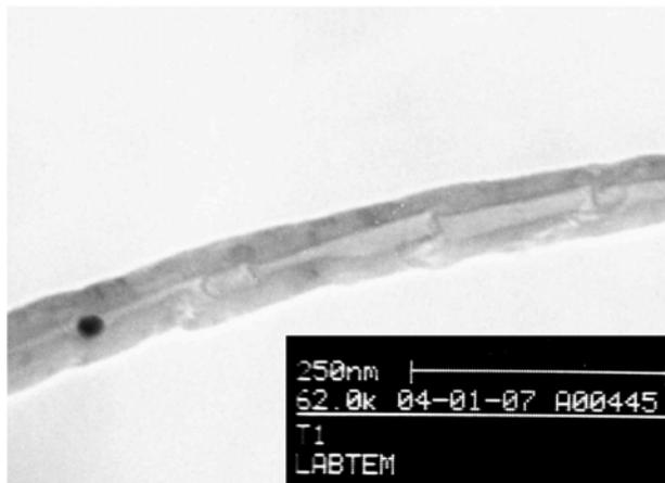
**Figura 4.** Fotografía con microscopio electrónico de transmisión de nanotubo de carbono tipo bambú obtenido por síntesis con microondas.
