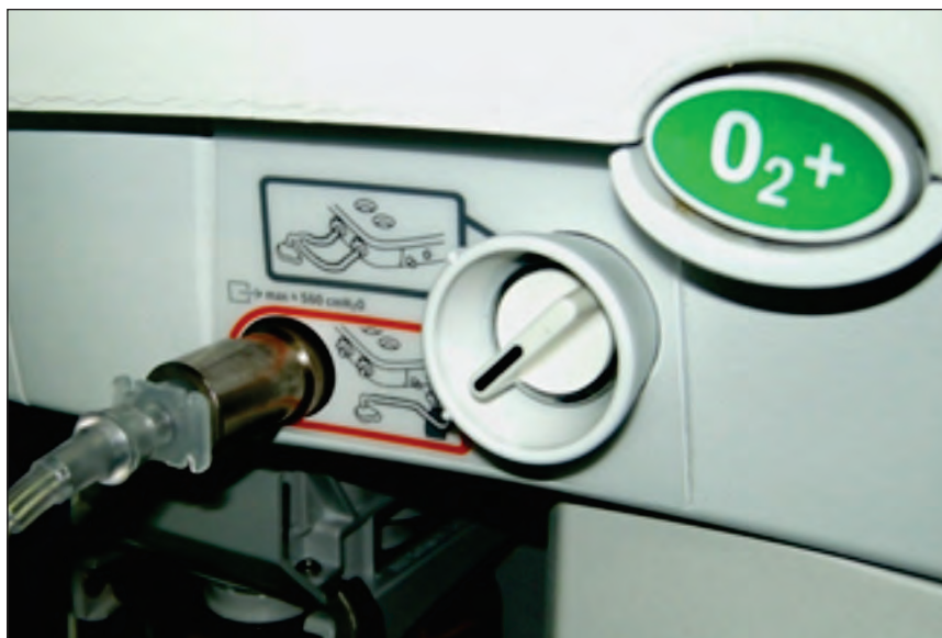
Figura 3c. Sistema de alta presión: la conexión de la manguera de oxígeno puede también hacerse a la salida auxiliar de gases frescos (ACGO) de una máquina de anestesia dotada de un conector universal de 15 mm de un tubo orotraqueal 4-4,5 mm de diámetro interno
